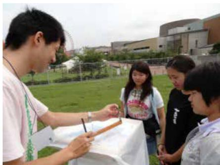
すえつけた平板測器（三脚、図板）上に貼られた地図の原図。手元にアリダード。
