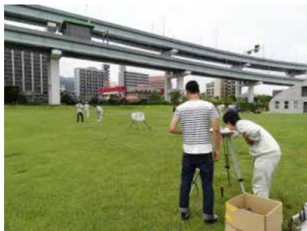
アリダードから目標物（ポール）を視準。向きを確定後、各測点までの距離を測定。
